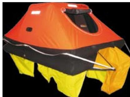
Rettungsinseln können sowohl offen als auch mit einem Dach versehen sein. Keterschutzsäcke verhindern, dass die Inseln im Sturm umschlagen. Die Verbindungsleine zum Schiff weist eine Sollbruchstelle auf, so dass eine Rettungsinsel von einem sinkenden Schiff nicht in die Tiefe gezogen werden kann. Nach dem Übersteigen sollte die Leine nach Möglichkeit sicherheitshalber mit einem Messer gekappt werden.
